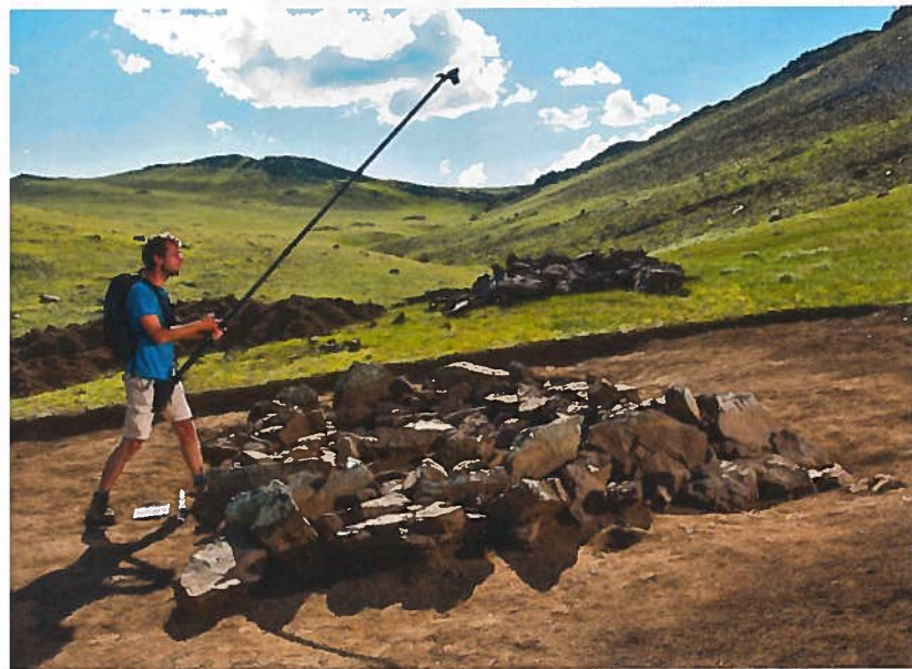
Josef Wilczek, doctorant au CNRS à Lyon, effectue un relevé de photogrammétrie sur un tertre : les pierres sont photographiées sous différents angles, puis la tombe est reconstituée en 3D.
